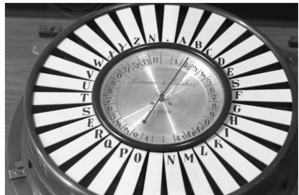
Das Gerät basiert auf einem Zeiger, der manuell eingestellt wird. Verstellt man den Zeiger des sendenden Apparats, stellt sich das
